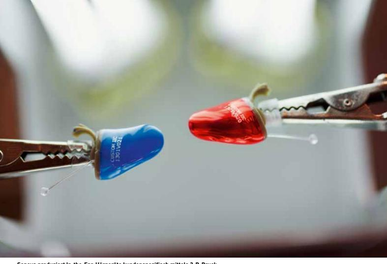
Sonova produziert In-the-Ear-Hörgeräte kundenspezifisch mittels 3-D-Druck.
